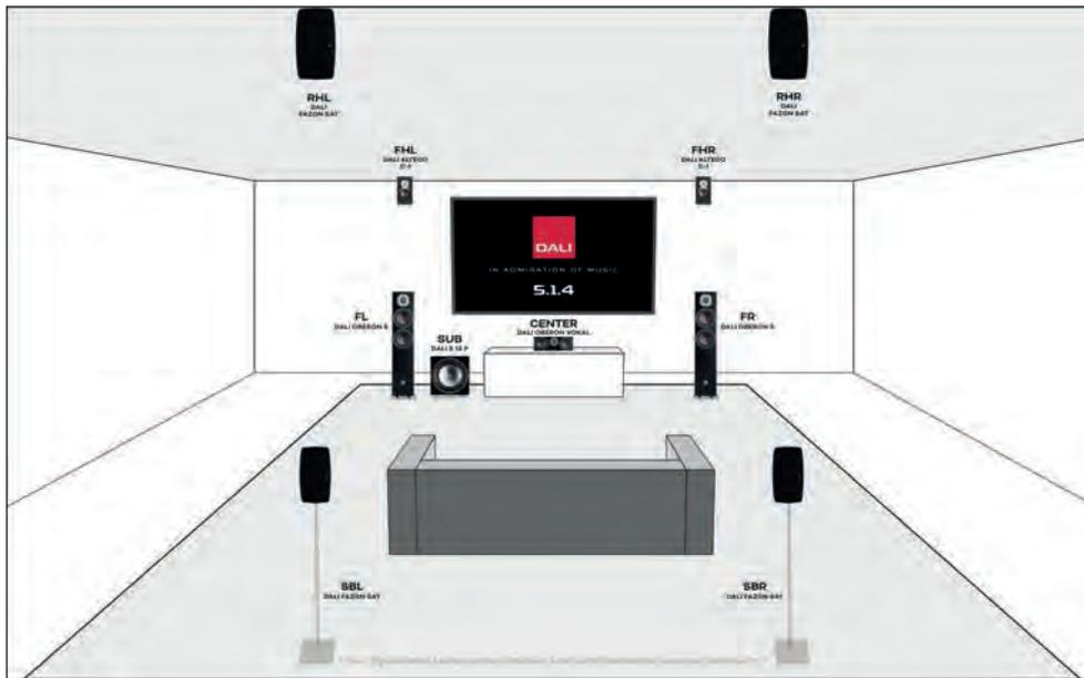
Die abgebildete 5.1.4-Konfiguration ist das Standard-Setup für entsprechende Mehrkanal-Tonformate. In unserem Beispiel werden diese DALI Lautsprecher eingesetzt:
